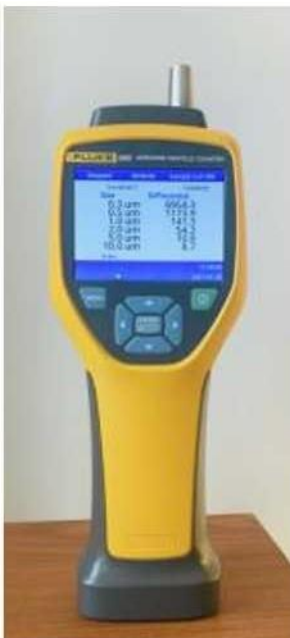
Figura 1. Il contatore di particelle, che misura il numero di particelle per litro d'aria di determinate dimensioni indicate nel display. Quando sono prodotti aerosol, questi sono visibili come aumento nei diversi canali rispetto alle particelle di fondo (polvere). Le dimensioni medie
